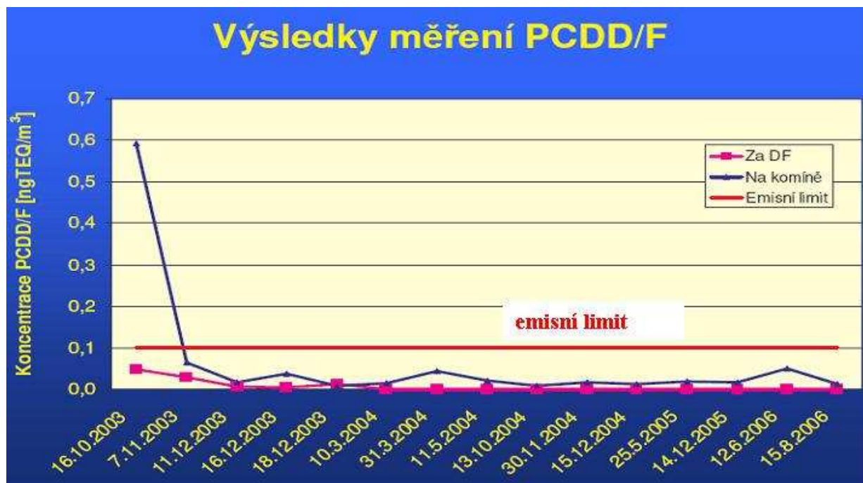
Obrázek č. 4 Výsledky měření koncentrace dioxinů na výstupu z dioxinového filtru
